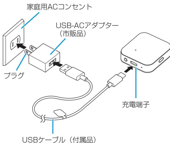
**1** USB-ACアダプターに、USBケーブル（付属品）を差し込む
